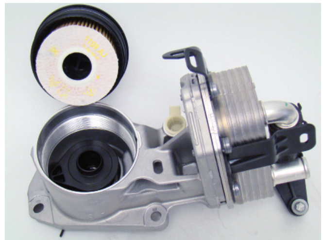
Olajszűrő ház integrált olajvisszafolyó szeleppel
