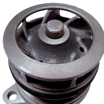
2. ábra: 65424 fémből készült vízpumpa (új)
