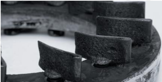
VTG: Az erős olajkocsz lerakódás eltömítette a mechanizmust.
