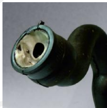
Forgattyúház szellőzés: eldugult egy kondenzátumból és motorolajból álló emulzió miatt
