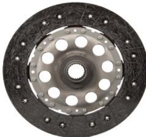
2. ábra: A kuplungtárcsa első gyári beszerelése (Átmérő 240 mm)
