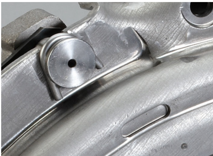
2. ábra: A szerelőkenyveket a lépcsős csapszeg és a kuplungház közé helyezik be.
