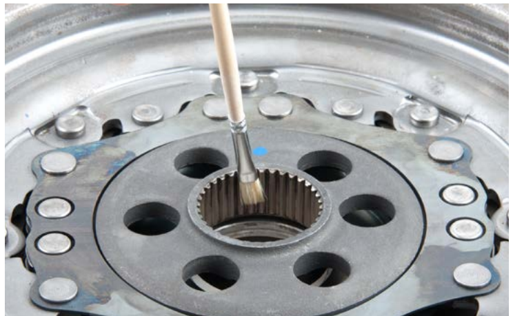
1. ábra: A DMF belső fogazását minden egyes javításkor kissé be kellene zsírozni
