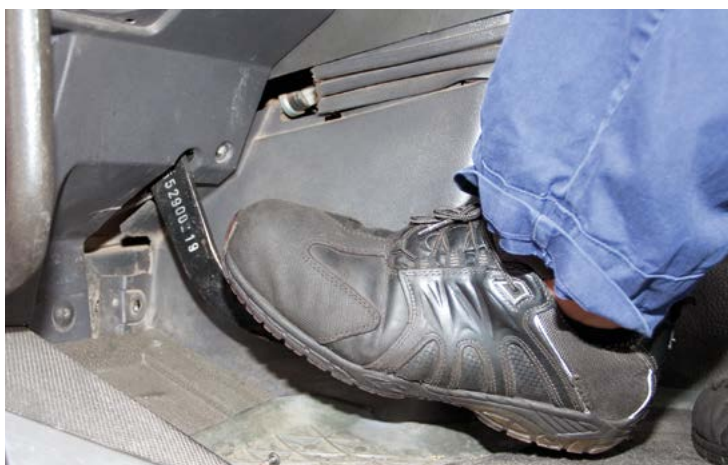
1. ábra: A pedál hibás működtetése esetén megszakad a tengelykapcsolási művelet
