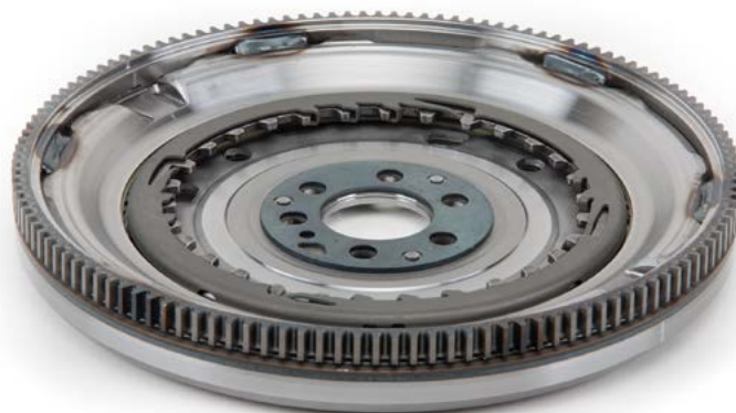
1. ábra: Az új indító fogaskoszorú fogszámanak meg kell egyeznie a régiek a fogszámaival
