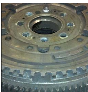
1. ábra: A jeladó gyűrű eddigi kivitele 2. ábra: A jeladó gyűrű új kivitele
