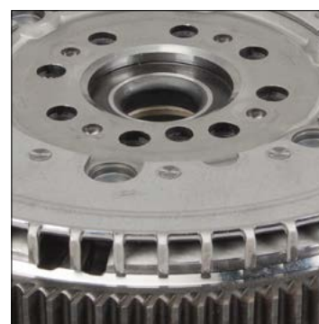
1. ábra: A jeladó gyűrű eddigi kivitele 2. ábra: A jeladó gyűrű új kivitele
