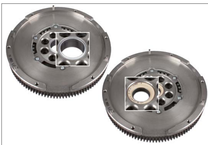
1. ábra: A 415 0388 10 cikkszámú LuK DMF siklócsapággal (bal) és golyócsapággal (jobb) összehasonlítása
