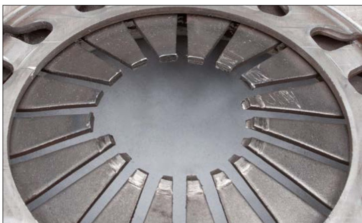
1. ábra: Hibás tányérrugó a hiányzó előfeszítés miatt
