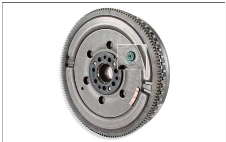
1. ábra: LuK DMF reteszelő csappal szállítási biztosításként
