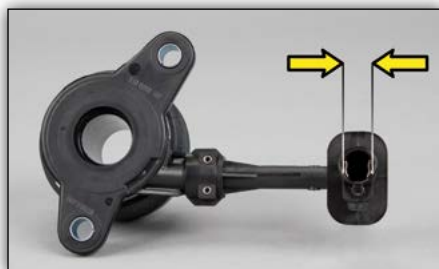
1. ábra: LuK CSC 510 0090 10 Hidraulikacsatlakozás 12,2 mm
