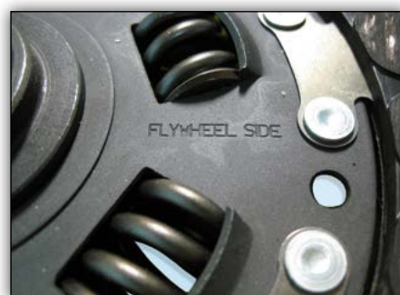
Bild 1-4: mögliche Beschriftungen auf der Kupplungsscheibe
