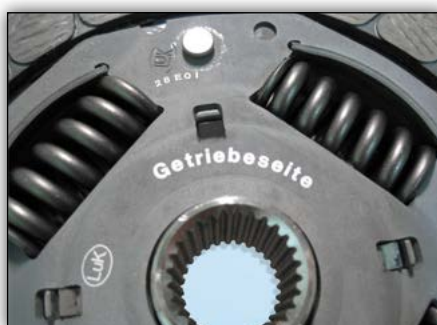
Bild 1-4: mögliche Beschriftungen auf der Kupplungsscheibe
