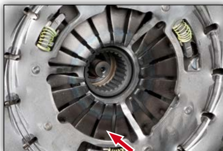
2. ábra: 415 0377 10 szerelt tengelykapcsolóval (SAC)
