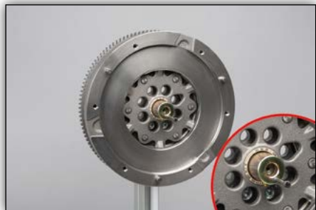
4. ábra: A központosító hüvelyt a tengelykapcsoló szerelése előtt helyezze fel (ügyeljen a ráhelyezett csavarra)
