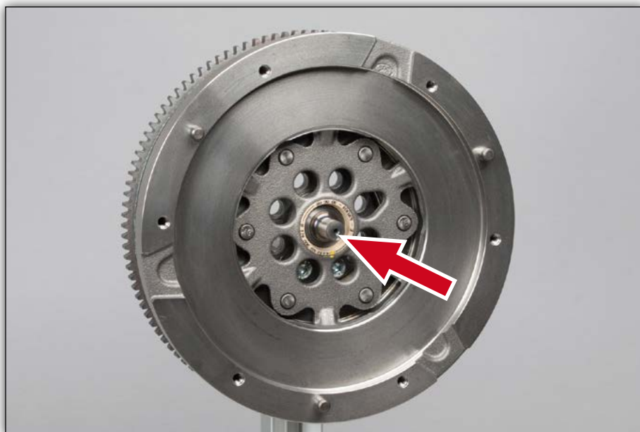
1. ábra: Vezetőcsap a 415 0377 10 cikkszámú DMF-en
