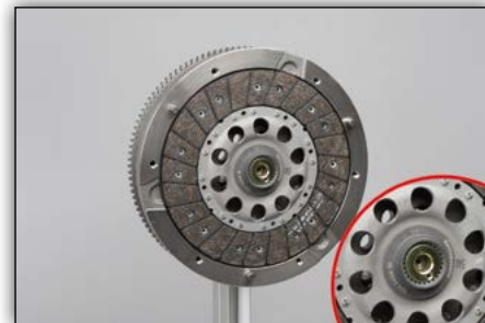
6. ábra: Távolítsa el a csavart a központosító hüvelyből
