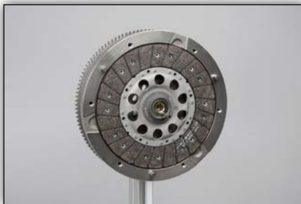
5. ábra: Helyezze fel a tengelykapcsoló-tárcsát
