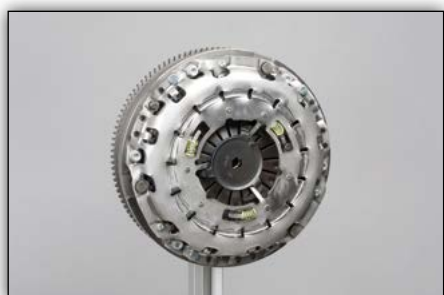
7. ábra: Helyezze fel a tengelykapcsoló nyomólapot és húzza meg a csavarokat a gyártó által megadott meghúzási nyomatékkal
