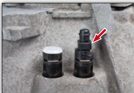
8. ábra: A légtelenítő gombot kézzel vagy 13-as villáskulccsal lehet működtetni
