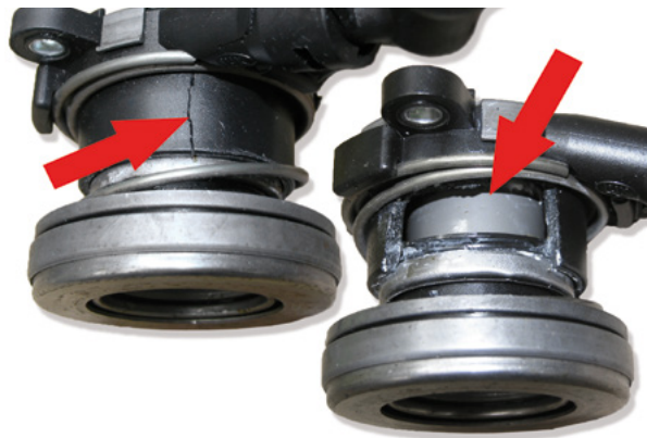
5. ábra: A hibás beszerelés miatt tönkrement központi kinyomó
