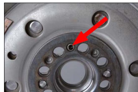
2. ábra: Illesztőfurat a kettős tömegű lendkerékben a forgattyútengely felőli oldalon
