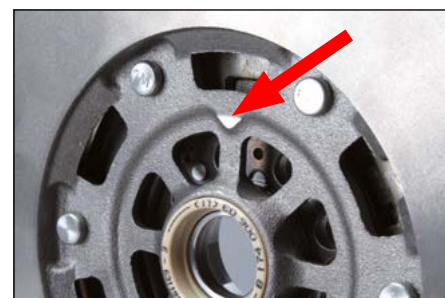
3. ábra: Az illesztőfurat jelölése egy háromszögletű jellel a kettős tömegű lendkerék sebességváltó felőli oldalán
